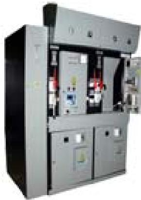
Камера КСО предназначены для работы в электрических установках трехфазного переменного тока частотой 50 и 60 Гц напряжением 6 и 10 кВ в системах с изолированной или заземленной через дугогасящий реактор нейтралью.
